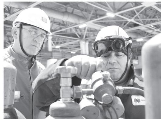
«Норильсктрансремонт» вслед за Механическим заводом НОК перешёл на природный газ. Им заменили ацетилен, который использовался при газорезательных работах. Переход на природный газ позволит «Норильсктрансремонт» уменьшить себестоимость продукции на участке по ремонту подвижного состава и снизить вредное воздействие на окружающую среду.
