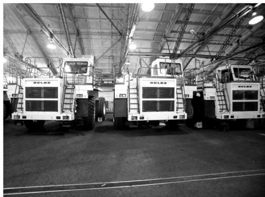
ЦАТК получил 20 новых карьерных самосвалов БелАЗ-7555В. Техника поступила в разобранном виде. Сборкой машин занимается московский поставщик «Белтранслогистик», а кузовов – ПО «Норильсктрансремонт» ООО «Норильскникельремонт». На сборку, сварку и усиление износостойким материалом одного кузова уходит восемь-девять рабочих смен.
