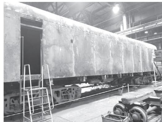
Специалисты участка по ремонту подвижного состава и участка механоэнергетического оборудования ПО «Норильсктрансремонт» продолжают капитальный ремонт весоупорочного вагона. Он эксплуатируется на Надеждинском металлургическом заводе и предназначен для проведения поверки вагонных весов.
